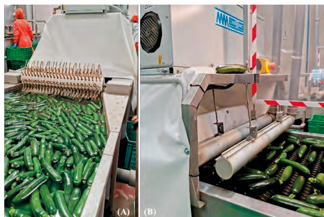
Figura 14. Frutti di zuccina in fase di pre-lavaggio (A) e post-lavaggio con acqua ozonizzata a temperatura ambiente (B)
